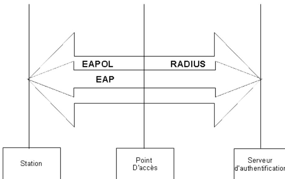
Figure 7 : Encapsulation EAP
